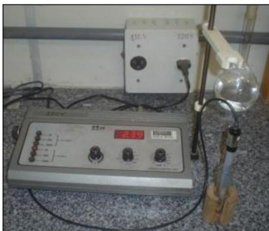
Figura 3.20: Modelo de condutivímetro (Fonte: Facíola, 2009).
