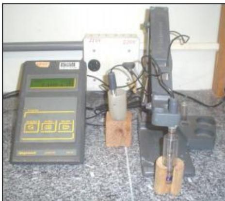
Figura 3.19: Modelo de peagômetro (Fonte: Facíola, 2009).
