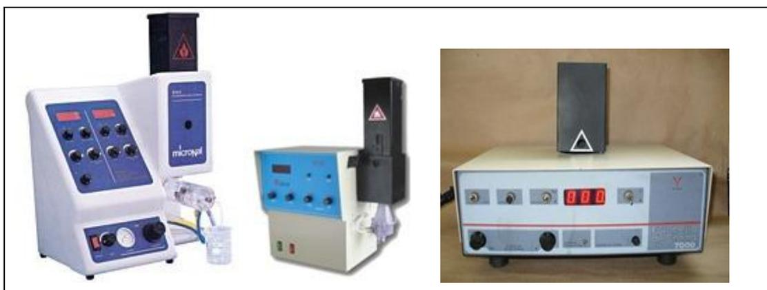
Figura 3.17: Exemplos de fotômetros (Fonte: Facíola, 2009).
