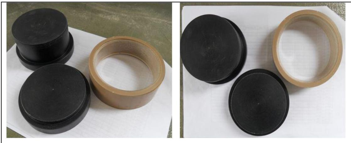
Figura 3.15: Aparato empregado para compactação dos corpos de prova.
