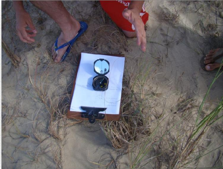
**Figura 8 - Manuseio da bússola e obtenção da ortogonal à linha de costa**
