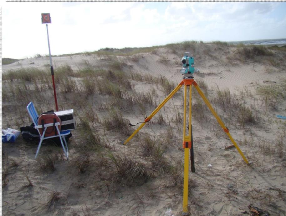
**Figura 15 - Equipamentos utilizados para realização do perfil de praia**
