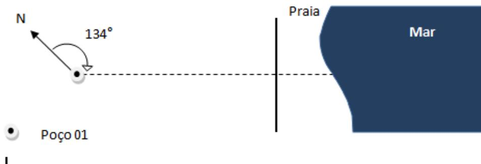
**Figura 7 - Esquema de orientação ortogonal realizado no trabalho**
