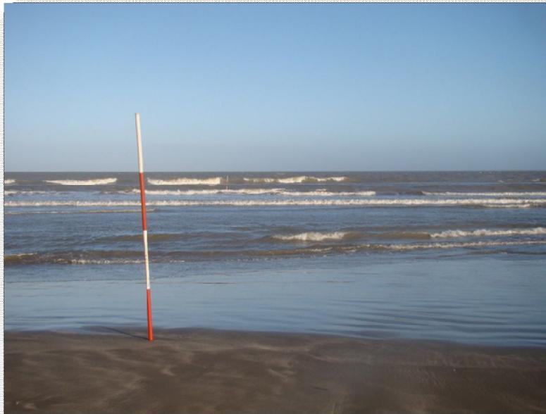
**Figura 9 - Baliza próxima a Linha d'água auxiliando a medição da distância da linha ortogonal**
