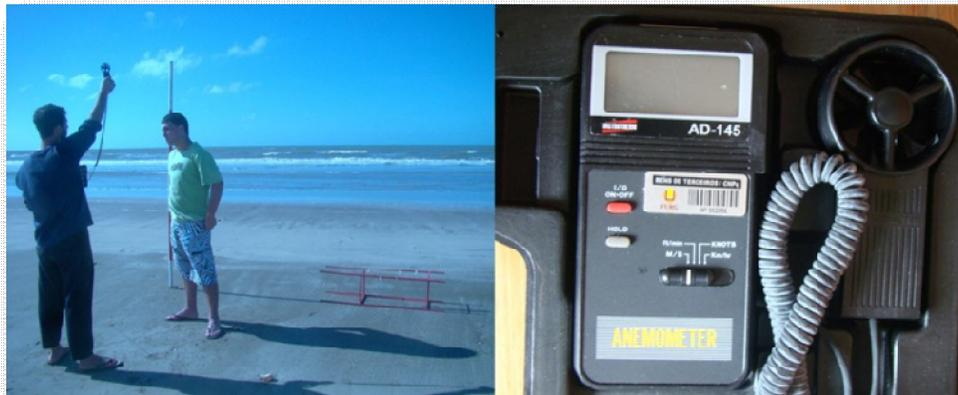
**Figura 10 - Medição da intensidade do vento através do anemômetro a 2m de altura**
