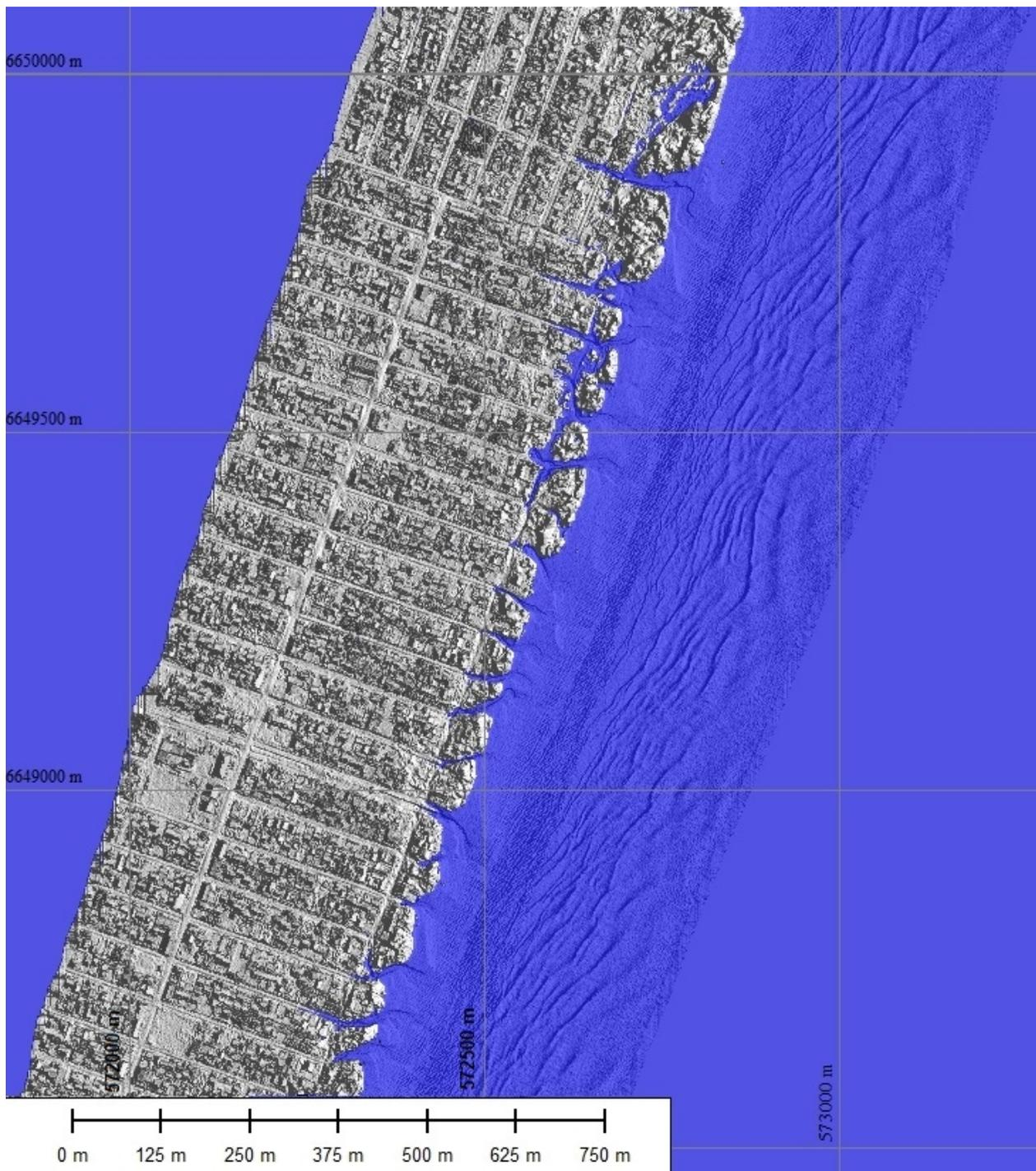
Figura 5.169 – Ação de evento extremo no balneário Magistério, na imagem é possível visualizar a transposição do cordão de dunas frontais pelas ondas.
