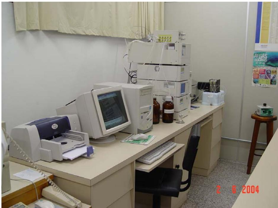
**Figura 15.** Sistema de cromatografia líquida (HPLC), com seus periféricos.
