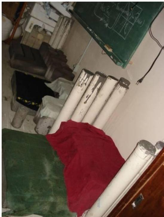
Fig. 3.26– Condições de cura úmida dos CP's.
