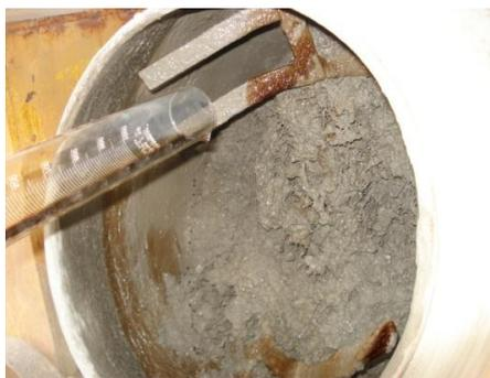
Fig. 3.10 – Adição de aditivo plastificante ao concreto.
