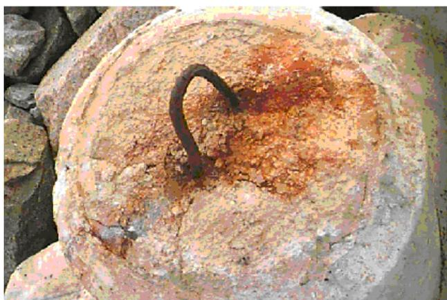
Fig. 2.21 – Fissuras junto à barra de aço.
