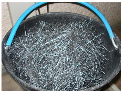
Fig. 3.21 – Fibras de aço utilizadas no ensaio de durabilidade.
