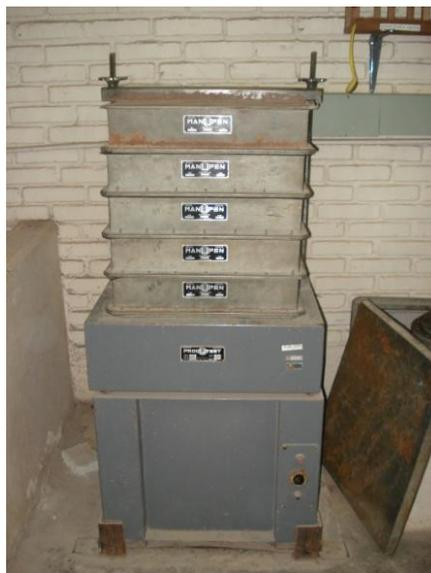
Fig. 3.8 – Peneiras no agitador para granulometria da brita.
