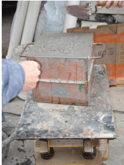
Fig. 3.18 – Peso específico do concreto fresco.
