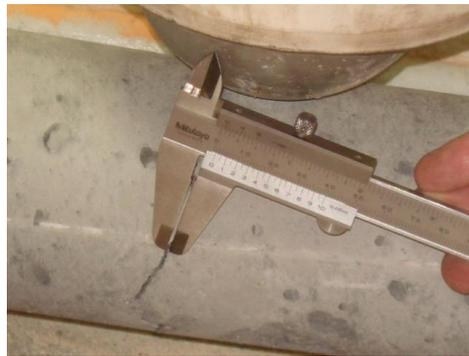
Fig. 3.29 – Fissura com abertura de 1 mm.
