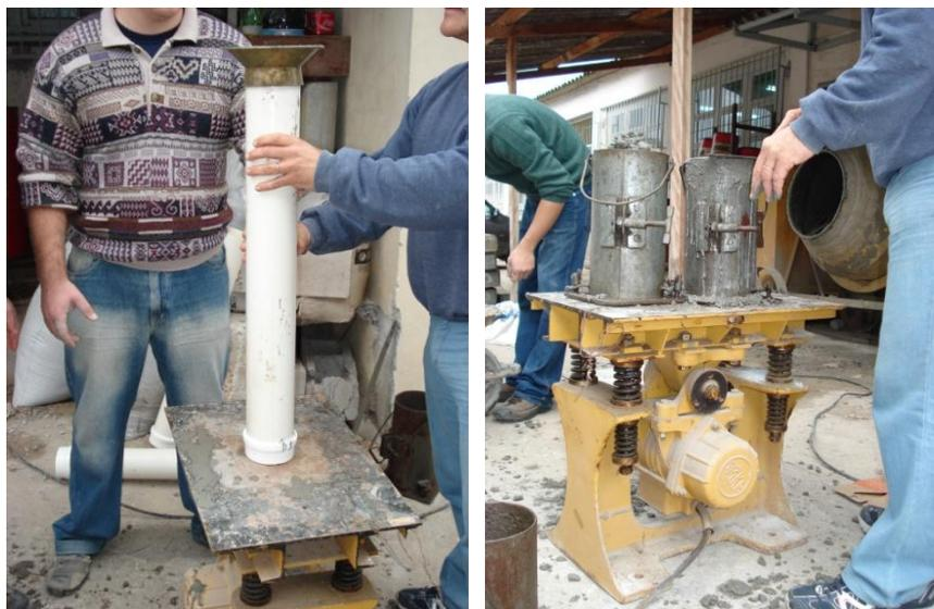
Fig. 3.16 – Adensamento por vibração mecânica externa.
