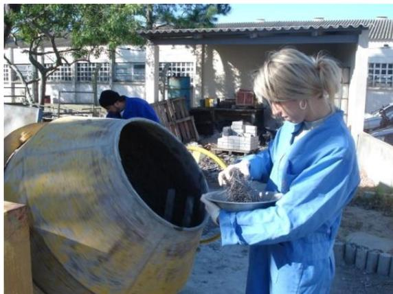
Fig. 3.15 – Inserção das fibras de aço ao concreto.
