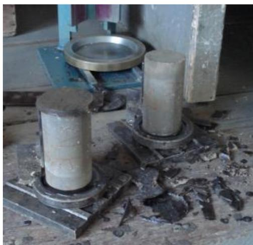
Fig. 3.4 – Capeamento dos corpos de prova.
