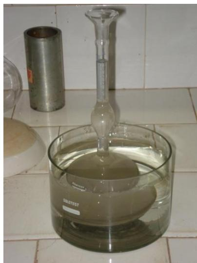
Fig. 3.2 – Ensaio de densidade do cimento.
