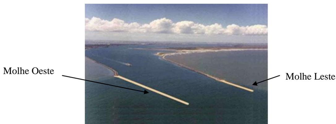
Fig. 2.10 – Prolongamento dos molhes da barra (DNIT, 2007).
