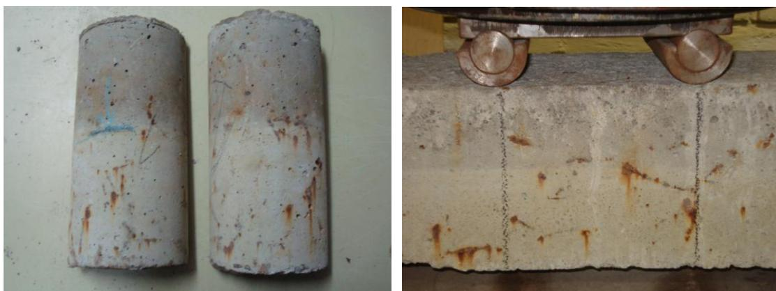
Fig. 4.1– Manchas superficiais no concreto após dois anos de ensaio.
