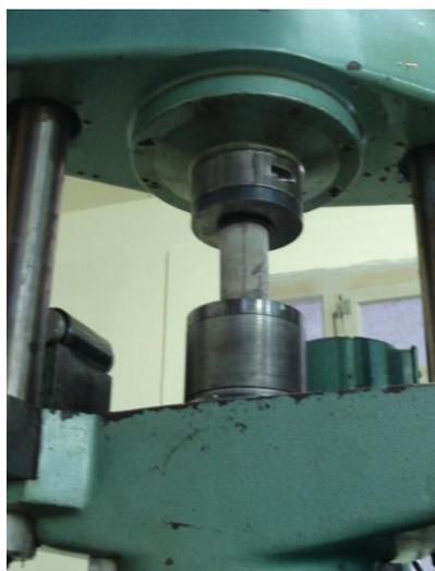
Fig. 3.20 – Ensaio de resistência à compressão (MIGLIORINI, 2007).
