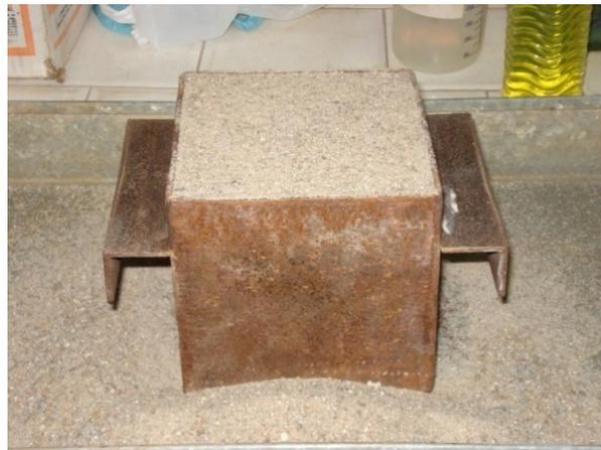
Fig. 3.6 – Massa específica aparente da areia.
