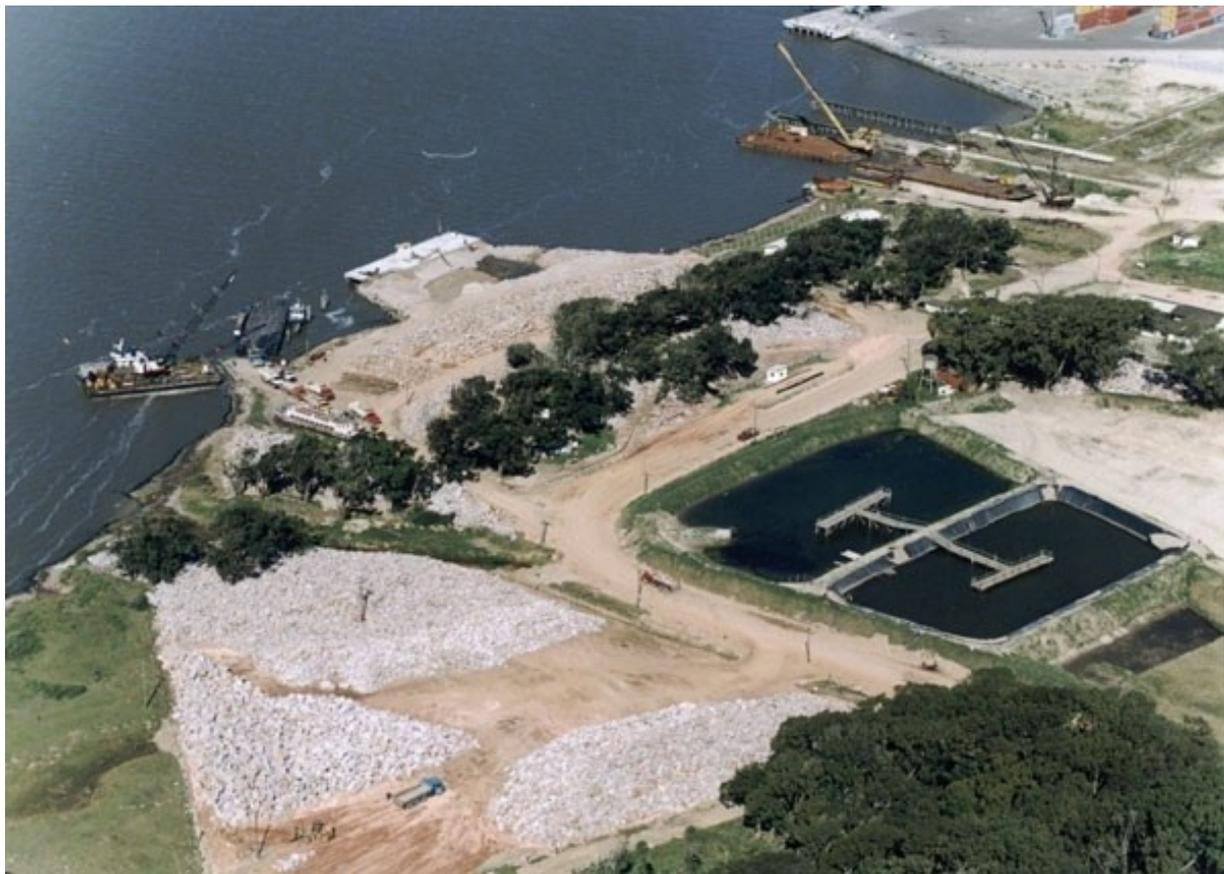
Figura 4. 2 – Bacias de sedimentação com a lama.
