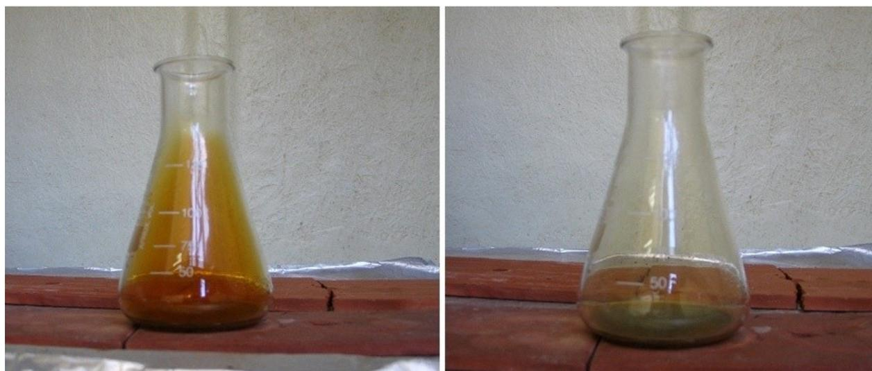
Figura 4. 15 – Amostra em solução ácida à temperatura ambiente em capela até que os fumos excessivos parem.
