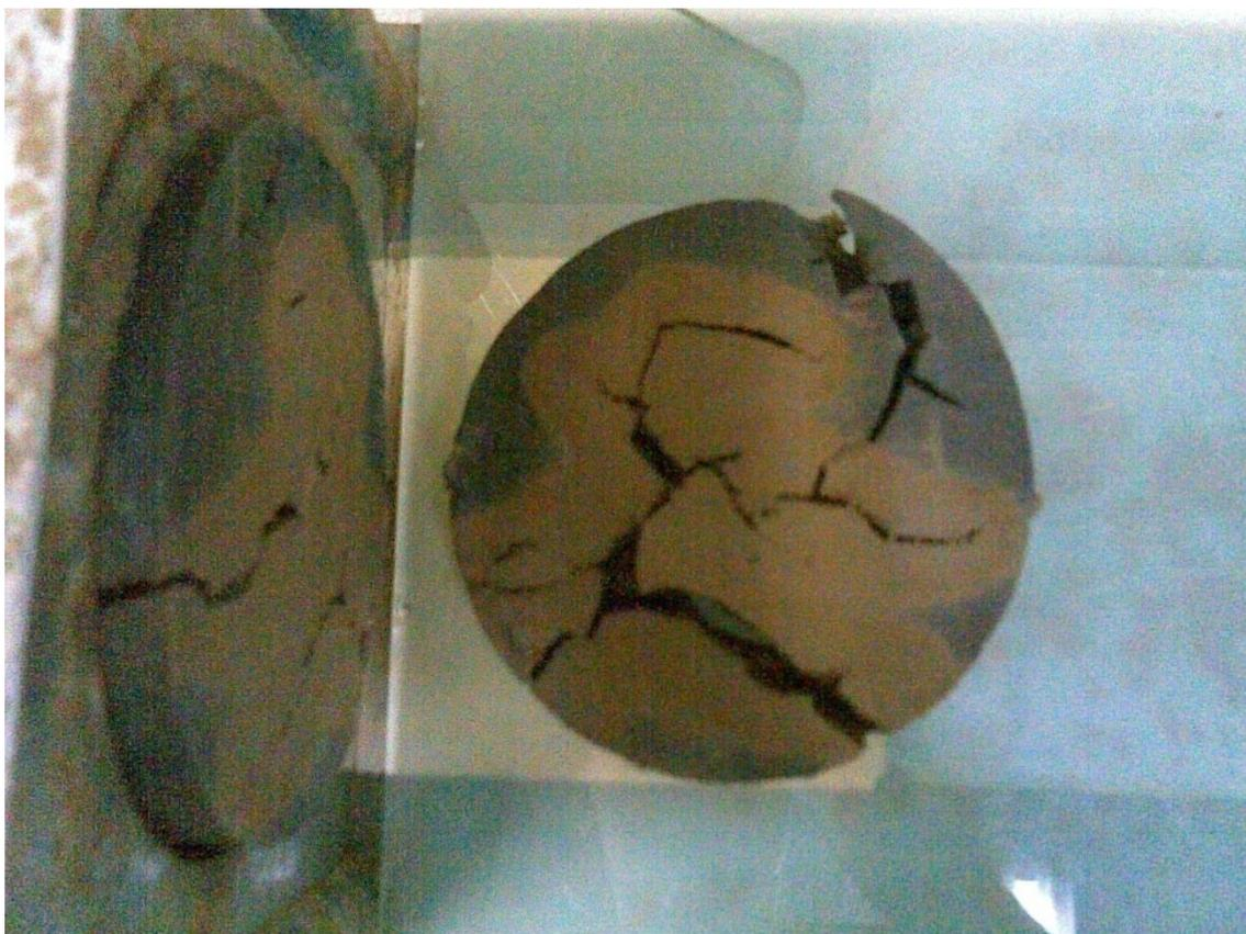
Figura 4. 10 – Amostra retirada do Shelby e cortada.
