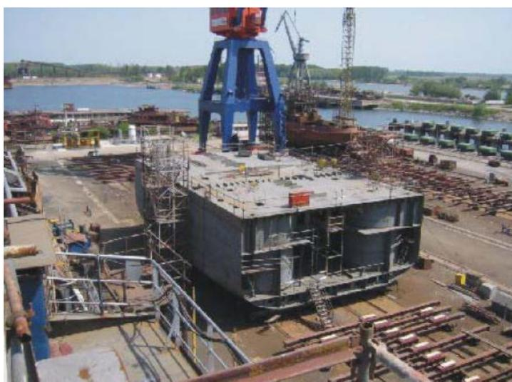
Figura 2.11 - Construção por blocos
