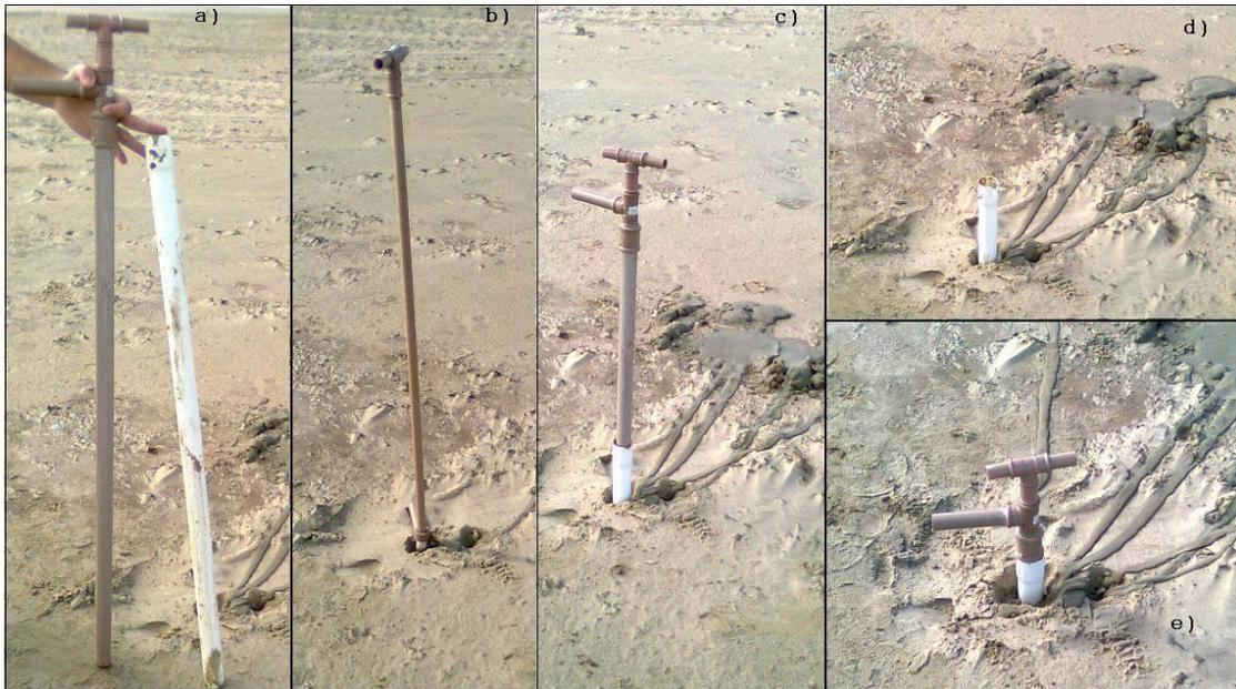
Figura 12 - Esquema de coleta de salinidade. a) equipamentos utilizados; b) inserção da bomba de vácuo no solo; c) bomba de vácuo inserida do tubo guia; d) retirada de sedimentos e água do tubo guia; e) detalhe dos equipamentos inseridos no solo após a coleta.
