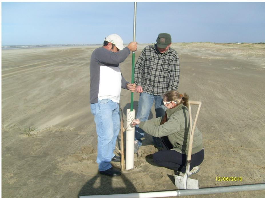
Figura 5 - Colocação do tubo guia para não desmoronar o solo.
