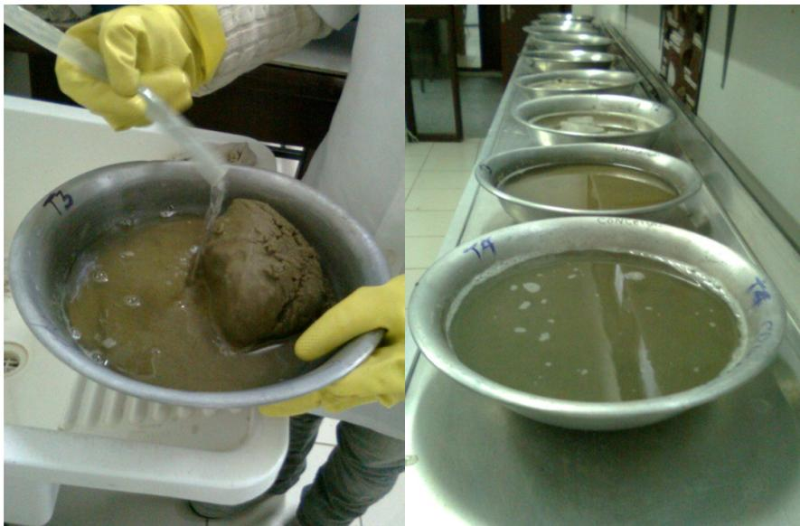
Figura 14 - Detalhe da lavagem do sedimento.
