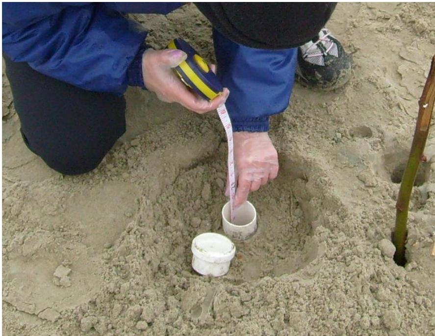
Figura 11 - Detalhe da leitura do nível freático.
