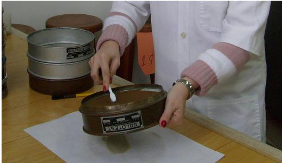
Figura 16 – Detalhe do peneiramento.
