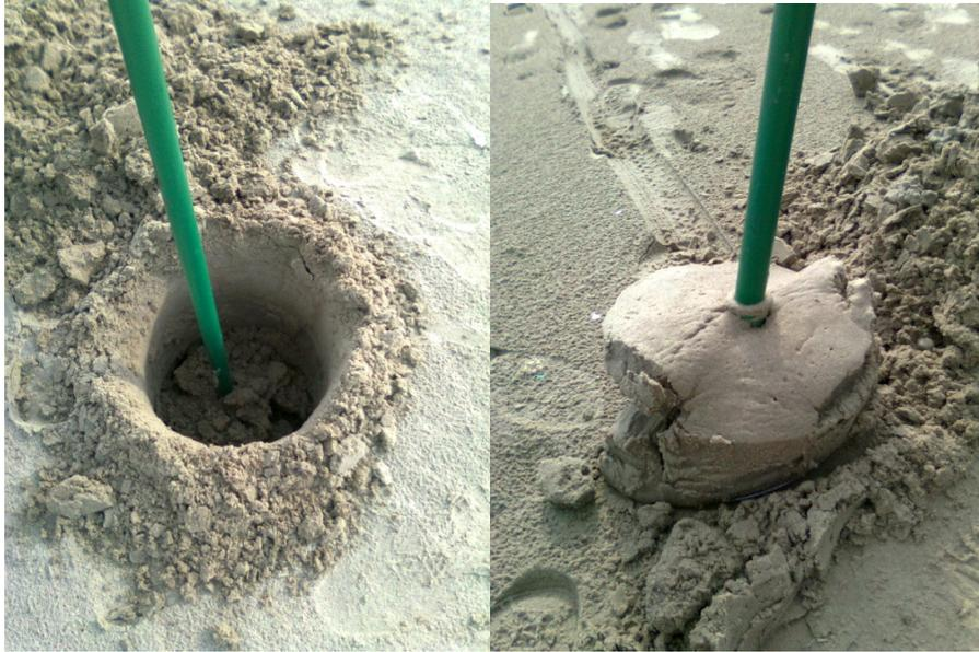
Figura 13 - Detalhe de coleta de sedimento.
