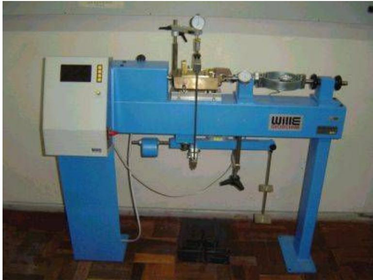
Figura 4.14 - Equipamento de cisalhamento direto do Laboratório de Geotecnia e Concreto da FURG
