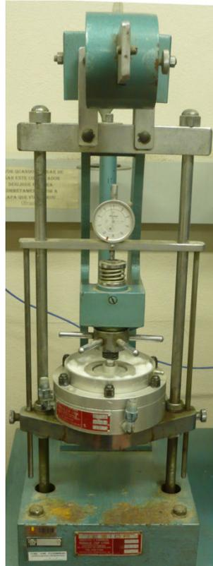
Figura 4.11 - Prensa oedométrica do Laboratório de Geotecnia e Concreto da FURG
