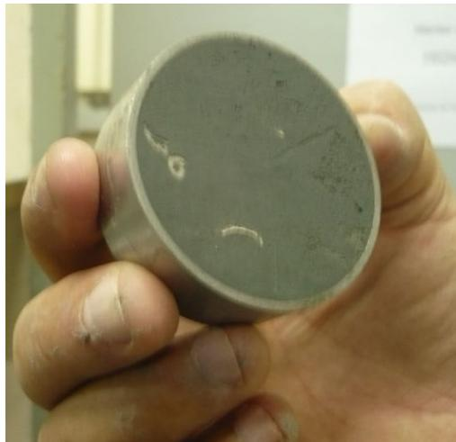
Figura 4.10 - Corpo de prova para o ensaio de adensamento (o material claro corresponde a irregulares e descontínuos veios de areia muito fina presentes na amostra)
