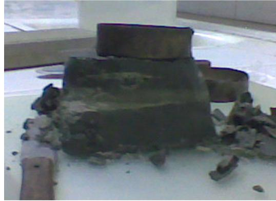
Figura 4.12 - Moldagem de corpo de prova para cisalhamento direto (camada argilosa - material escuro; lente de areia - material claro). (BASTOS et. al 2009)
