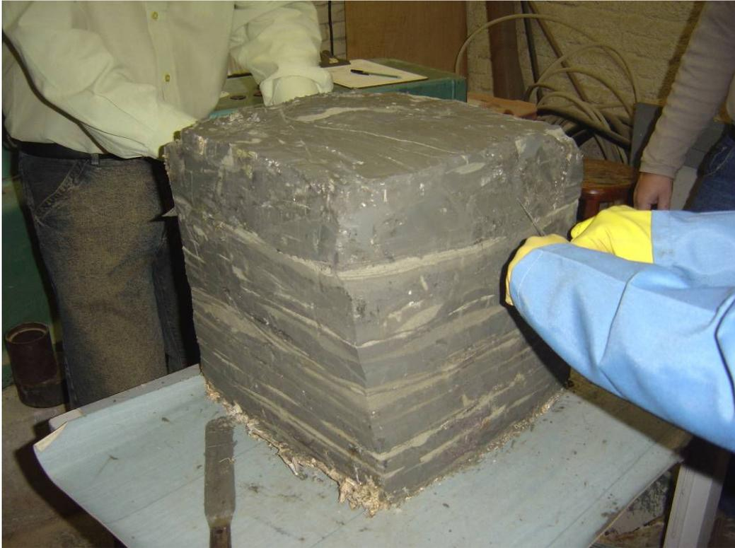
Figura 4.6 - Bloco coletado para realização de ensaios no processo de seccionamento dos volumes menores
